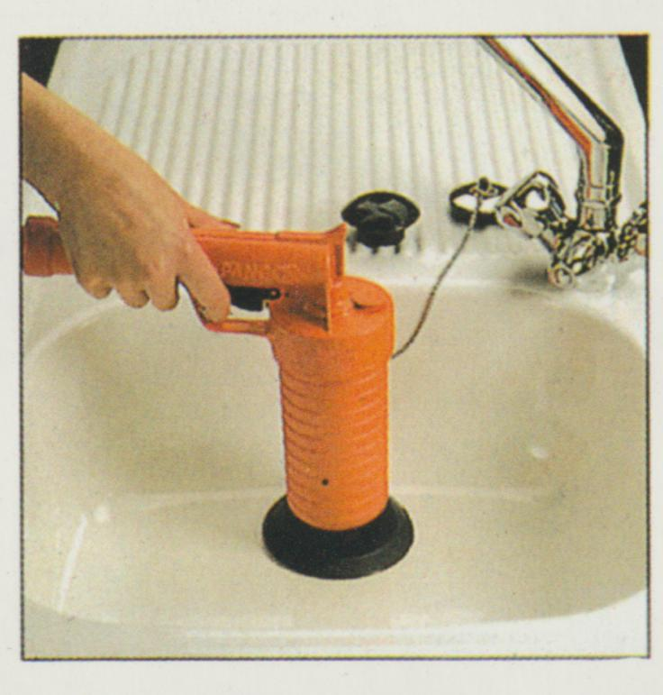
Colocar la boquilla en el agujero del desagüe atascado, presionar y pulsar el gatillo con energía; si se utiliza la boquilla grande, tapar el rebosadero con un trapo o esponja.
