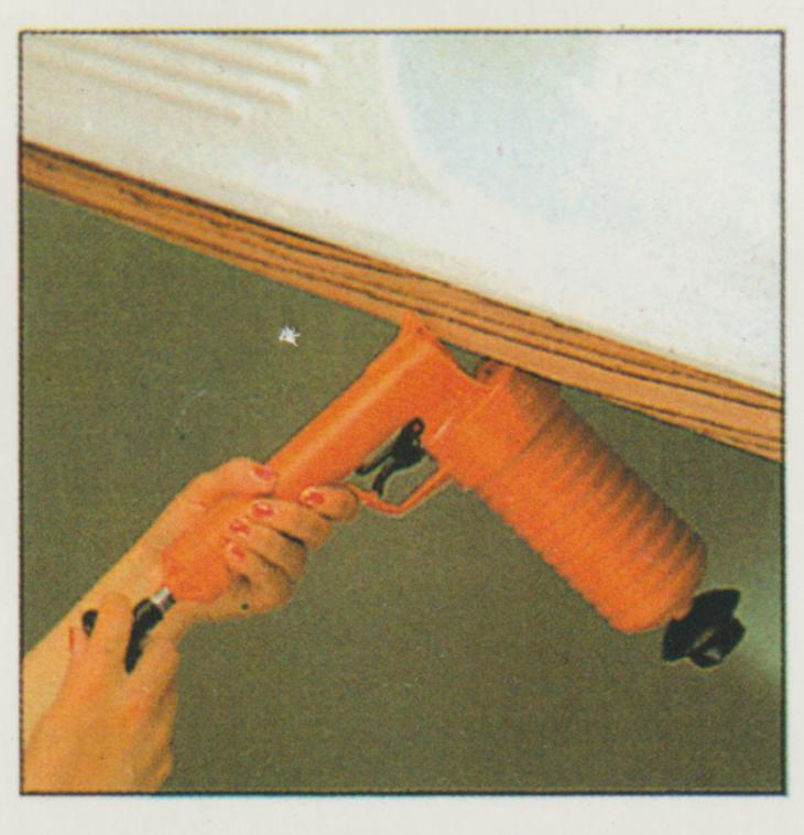
Sujetar el PANGO apoyándolo en cualquier superficie, llenar la cámara de aire bombeando con la mancha de 10 a 25 veces, y listo para disparar.
